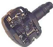
Sur les pédales de type SPD Shimano une vis de réglage permet d'ajuster la dureté de déclenchement pour les premiers essais dévisser au maximum cette vis
